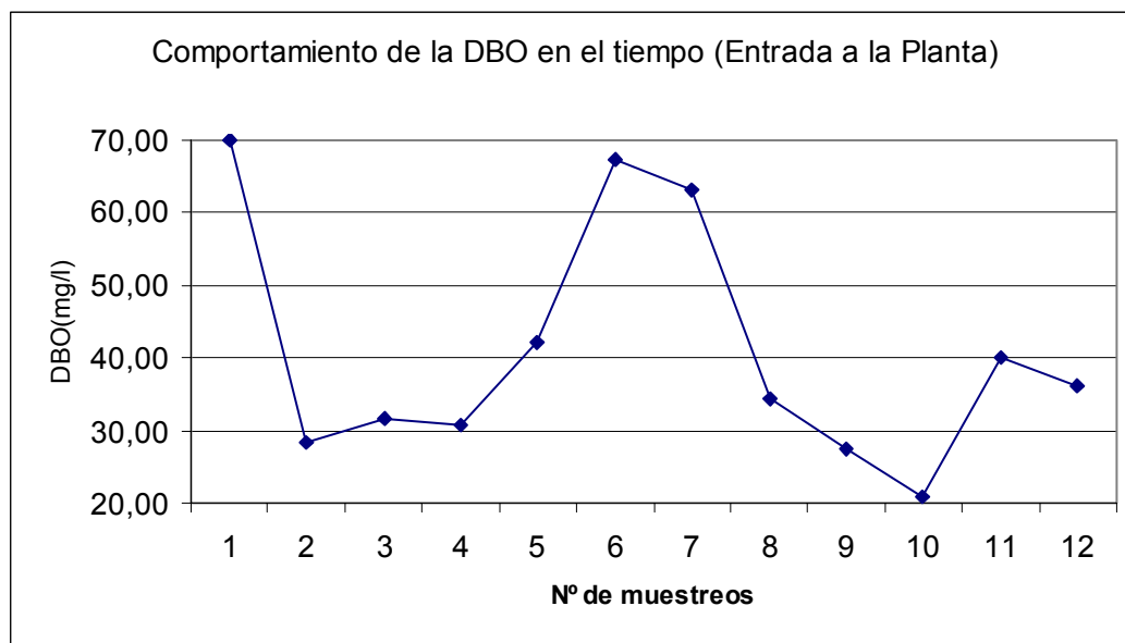
Gráfico N° 9. Comportamiento de la DBO en la Entrada a La Planta.
